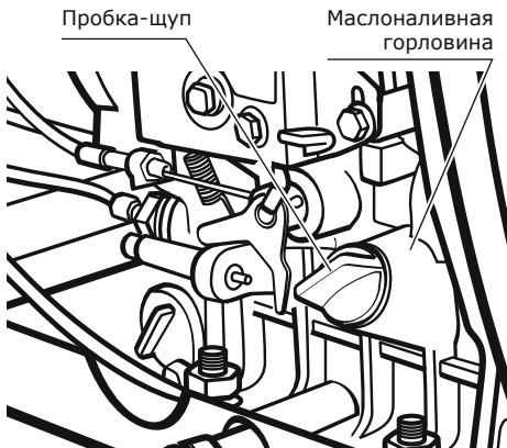
Рис. 11. Заполнение масляного картера и контроль уровня масла
