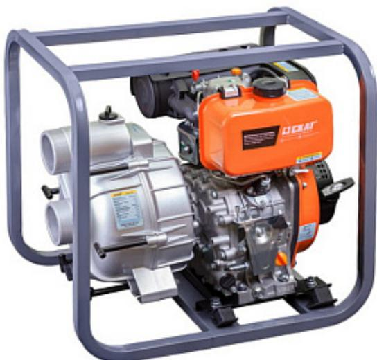
Грязевая мотопомпа МПД-1200 оснащена только ручным пуском и предназначена для перекачивания загрязнённой воды, в которой содержатся частицы песка, листьев и других примесей размером до 25 мм. Она поднимает воду на высоту восьмизэтажного дома и перекачивает до 1200 литров в минуту. МПД-1200 может применяться в строительстве, сельском и садовом хозяйстве, для осушения водоемов, бассейнов, колодцев и других затопленных объектов.
