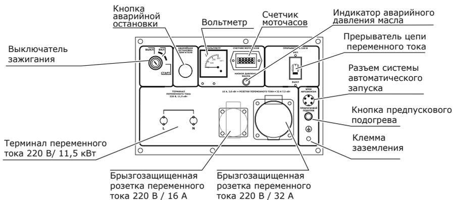
**Рис. 3. Схема панели управления генератора УГД-11500ЕТ**
