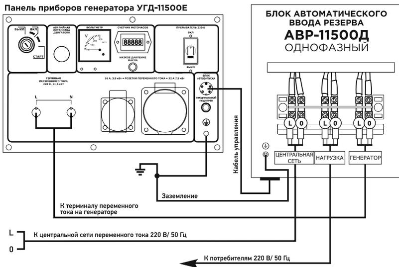
**Рис. 9. Схема подключения резерва АВР-11500ДТ**
