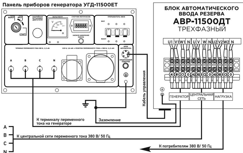
Рис. 10. Схема подключения блока АВР-11500Д к трехфазной сети
